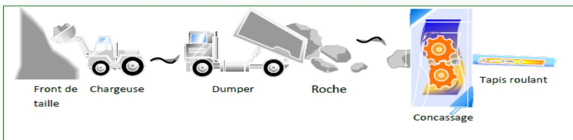
Figure 4: Processus de concassage
