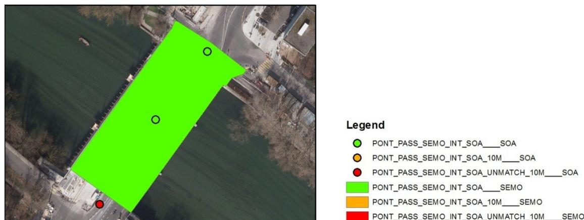
**Figure 5:** Exemple d'une erreur d'analyse de la comparaison entre les classes d'entités du SOA et du SEMO. Le polygone s'intersecte avec deux entités point alors qu'elles ne référencent pas le même objet, en l'occurrence le pont de Saint-Georges et le passage inférieur pour piétons en rive droite.
