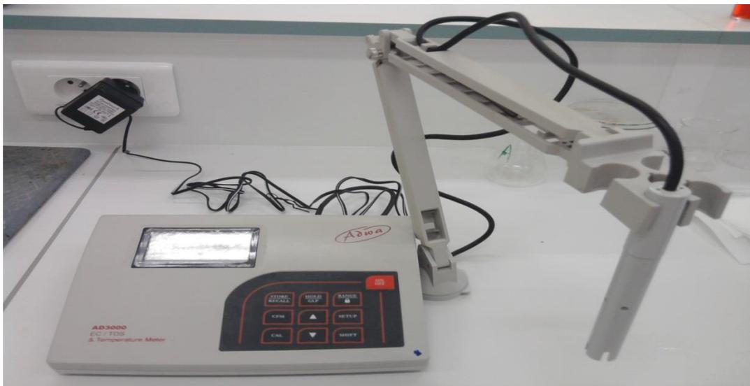
**Figure IV.4 :** Photo de conductimètre (laboratoire de chimie université Abou Bakr Belkaid – TLEMCEN-)
