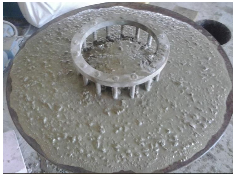
Figure 4.13. L'instabilité du béton (essai J-RING).
