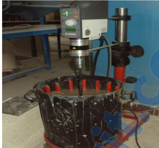
Figure 4.14. Rhéomètre utilisé pour les essais rhéologiques.
