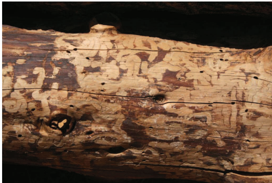
Photo. 4 : Tronc de Cèdre montrant des galeries et des trous de sortie d'insectes xylophage.
