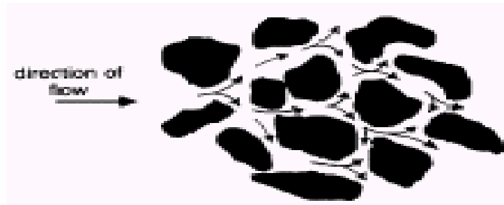
FIG IV.4 : Illustration de la dispersion cinématique
