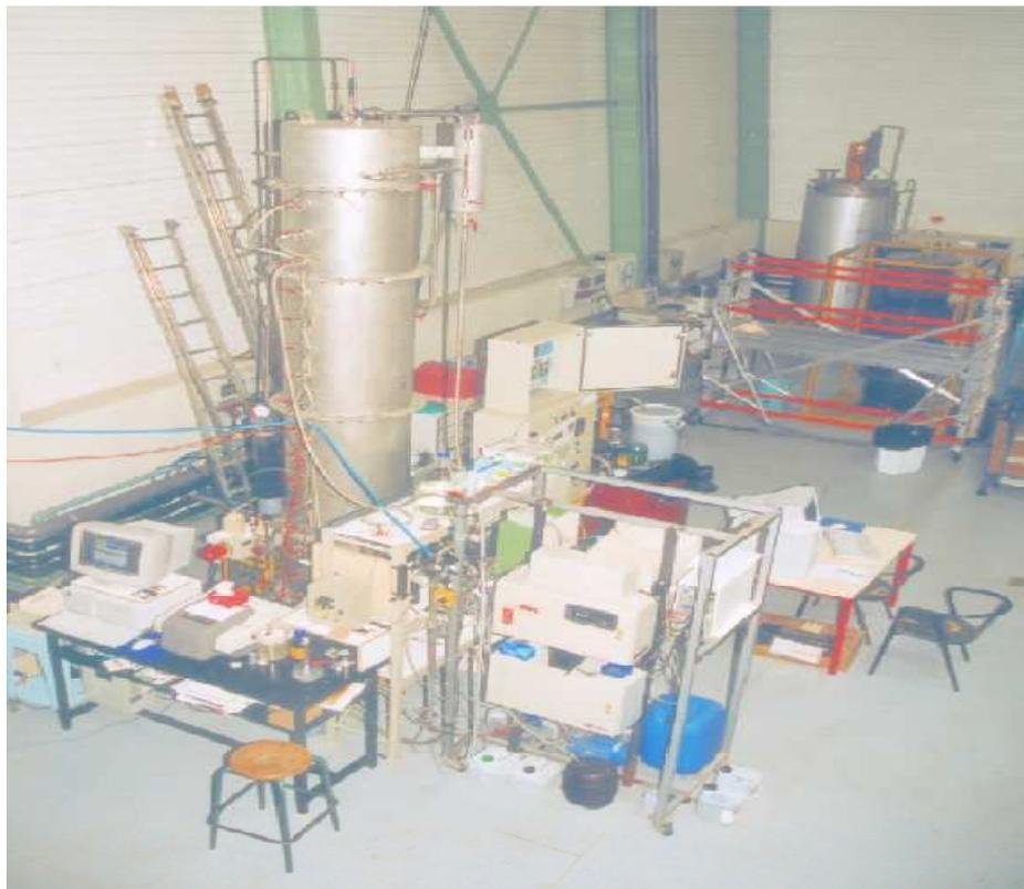
**Figure III-2 :** photographie du réacteur pilote pour le traitement des vinasses de distillerie et son instrumentation [Bernard et al., 2001]
