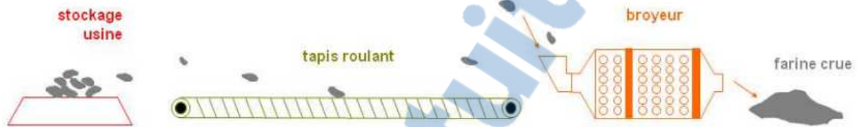
Figure 9 : Description du broyage du cru
