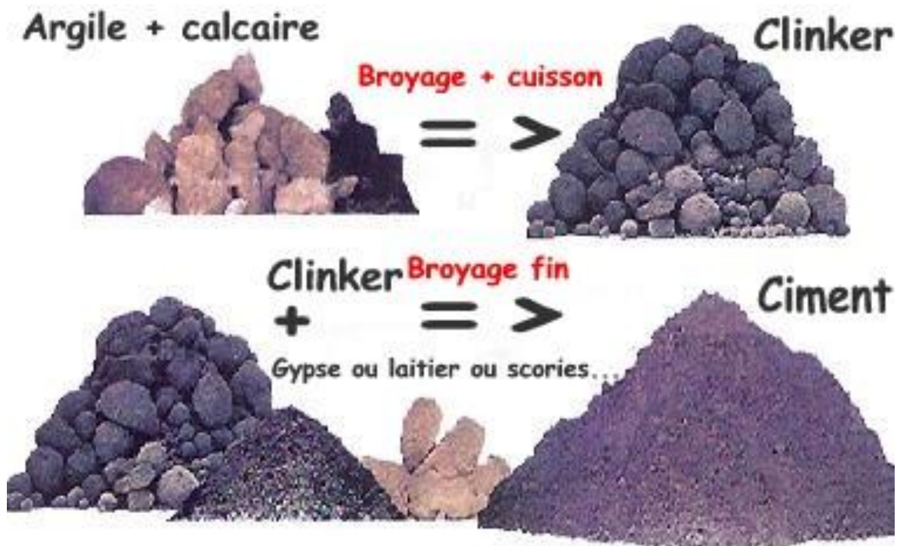
Figure 2 : Chaine de transformation de calcaire et d'argile en ciment
