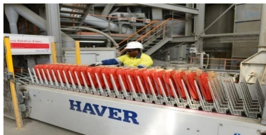
Figure 13: Ensachage du ciment CPJ35, CPJ45 en sacs
