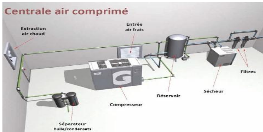
Figure16: Installation de production d'air comprimé
