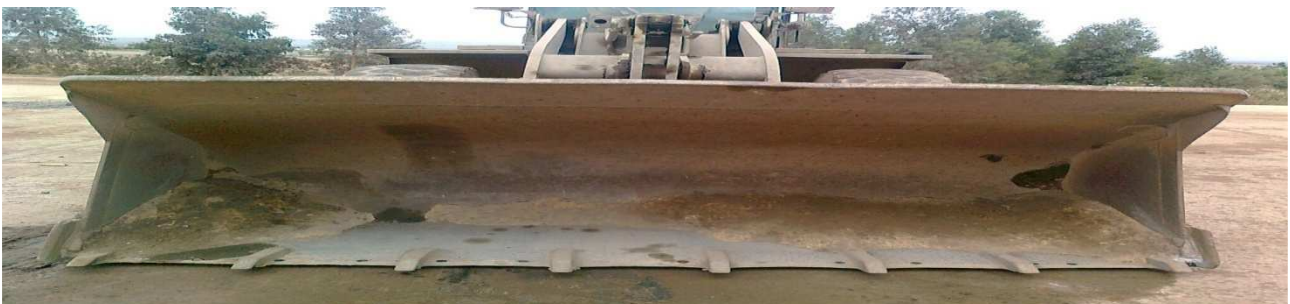
Figure 27 : Image montrant le collage de la matière sur le godet.
