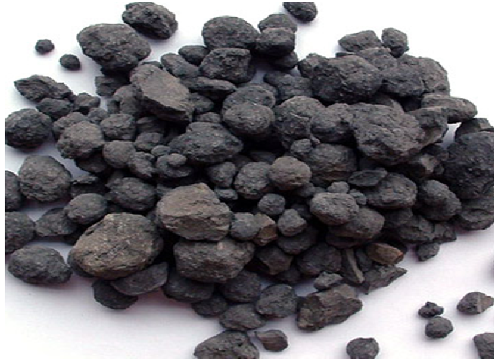
Figure 10:Aspect de clinker après refroidissement
