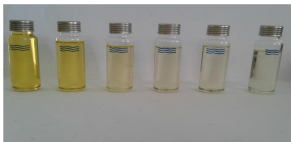
Figure 6: changement de la couleur sous l'effet de la terre
