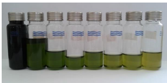
Figure 7: changement de la couleur sous l'effet de la terre décolorante.
