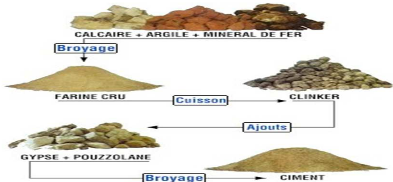
Figure 3 : Circuit de fabrication de ciment
