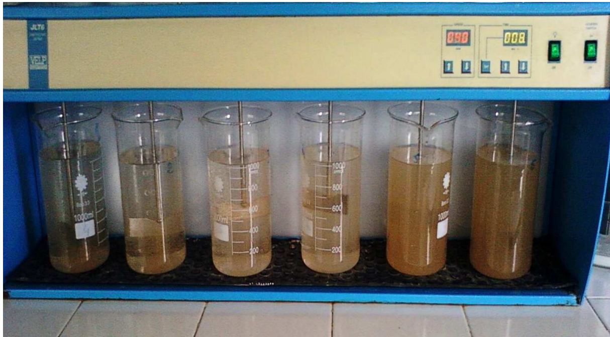
Figure 12 : Dispositif expérimental de l'essai de floculation (Jar-test)
