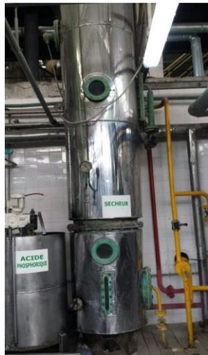
**Figure 14 : Sécheur sous vide**
