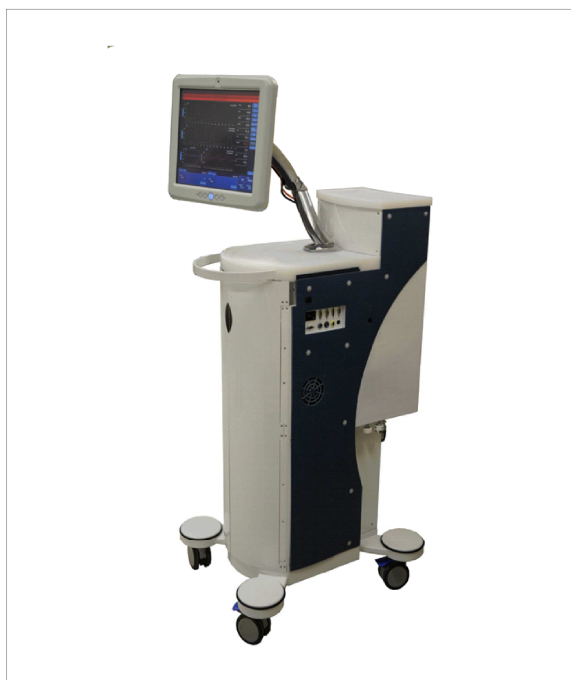
Figure 34 : Photographie du prototype de ventilateur liquidien INOLIVENT®
