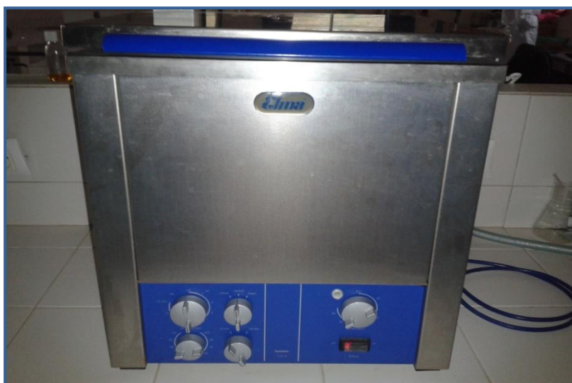
Figure 13 : sonicateur à bain d'eau
