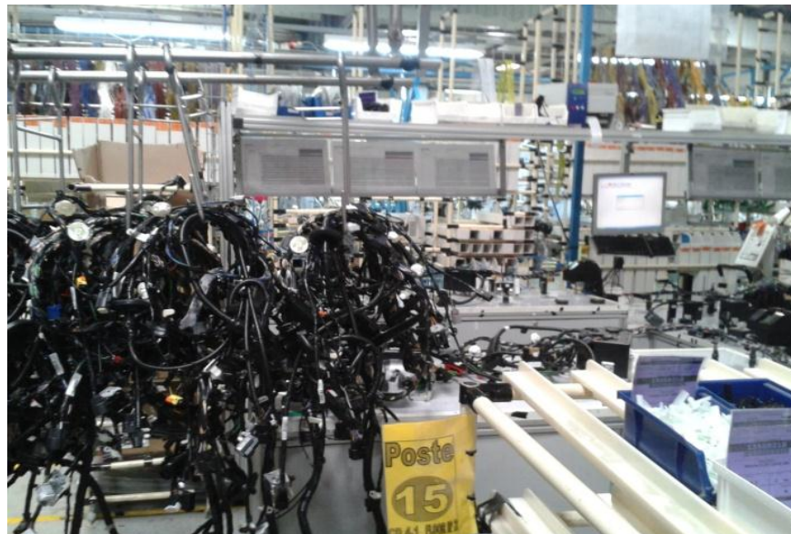
Figure 34 : Mal positionnement du moyen de connexion entre les postes de préparation
