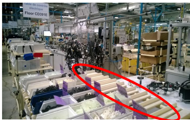
Figure 27 : Racks d'alimentation de la chaîne d'assemblage
