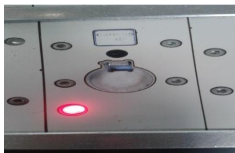
Figure 38 : Contre pièce du connecteur C4ME35 (4Door)
