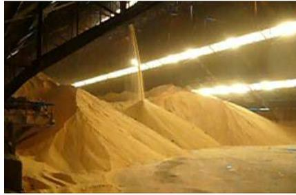
Le sucre est transféré vers la station d'affinage grâce à des bandes transporteuses en passant par deux servo-balances pour estimer la quantité de sucre introduite à l'usine (800 kg par pesée), un aimant pour éliminer les métaux ferreux, et un tamis pour isoler les grosses impuretés.
