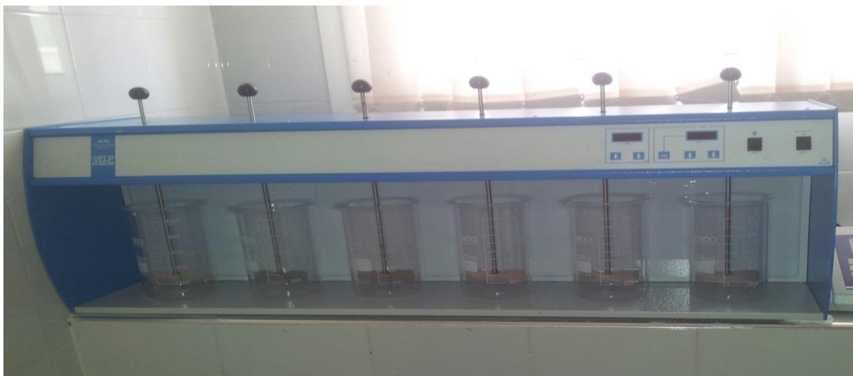
Figure 13 : Dispositif expérimental de l'essai de coagulation (Jar-test)
