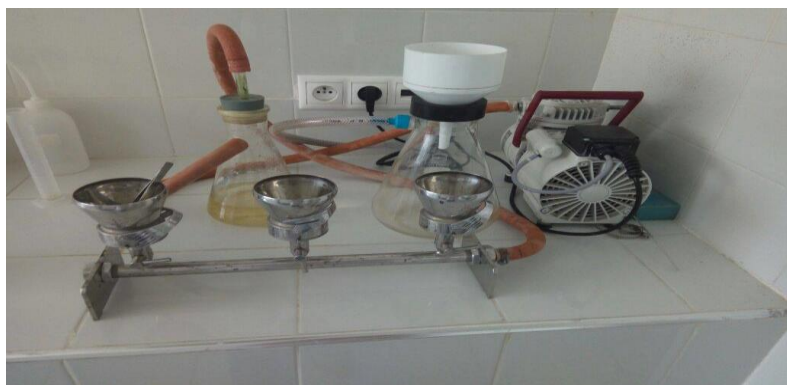
Figure 16 : L'unité de filtration à pompe
