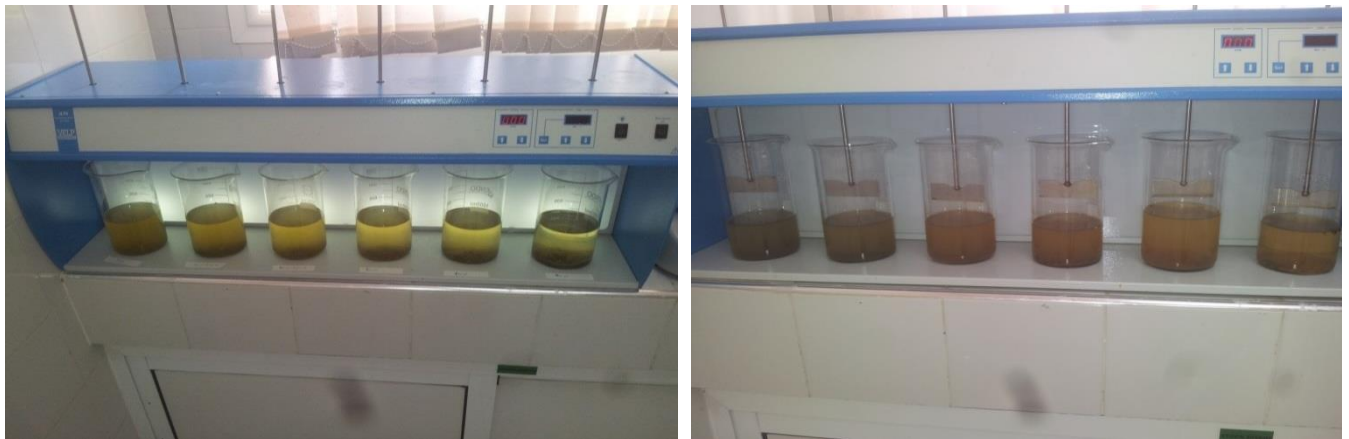
Figure 14 : Essai de coagulation avec Pax 18/ Sulfate ferrique
