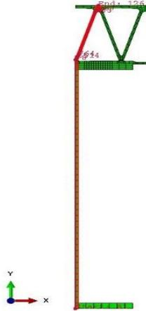
Figure 4-5 — Nœuds utilisés pour obtenir les contraintes axiales, les déformations axiales ainsi que la température
