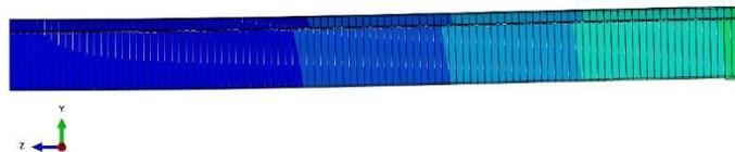
Figure C-140 — Flèche verticale (mm) de la poutre à l'ÉLUT #1, cas estival avec gradient positif, poutre de 25 m de long
