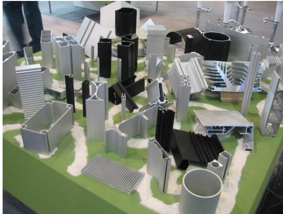
Figure 2-8 — Exemple de profilés réalisables par extrusion (CQRDA, s.d.)
