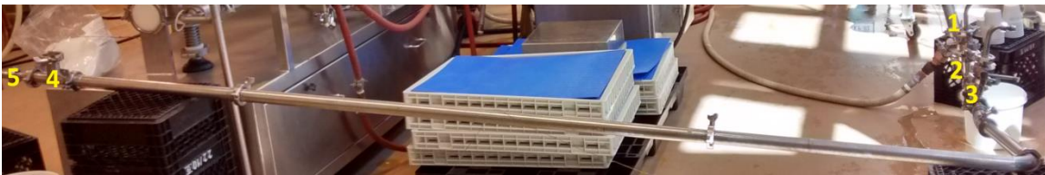
Figure 3.3: Section du BEP comportant la configuration linéaire: (1) Échangeur de chaleur tubulaire, (2) Thermocouple T2, (3) Buse de lissage de 425 µm, (4) Thermocouple T3, (5) Valve d'échantillonnage.
