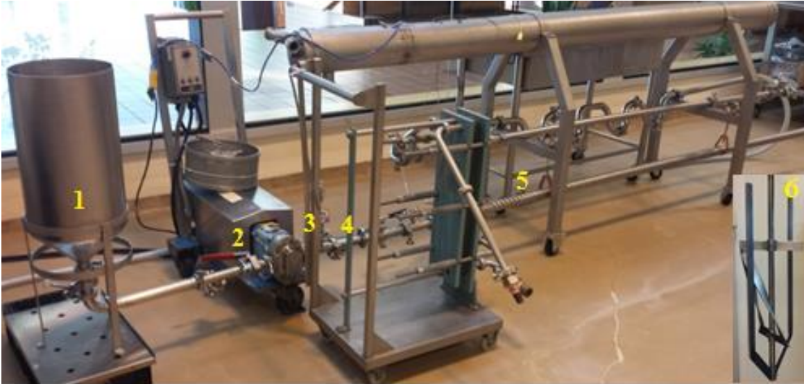
Figure 3.2: Section commune des configurations du BEP: (1) Cuve, (2) Pompe, (3) Thermocouple T1, (4) buse de 1.4 mm, (5) Échangeur de chaleur tubulaire, (6) mélangeur à pales hélicoïdales.
