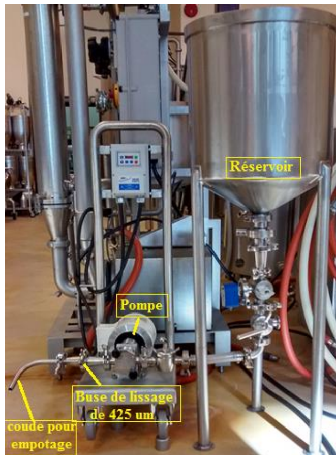
Figure 2.1 : Banc d'essai utilisé pour la production de yogourt brassé.
