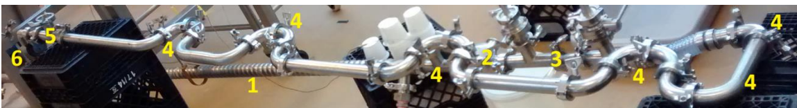
Figure 3.4: Section du BEP comportant la configuration tortueuse: (1) Échangeur de chaleur tubulaire, (2) Thermocouple T2, (3) Buse de lissage de 425 µm, (4) Coude en angle de 90°, (5) Thermocouple T3, (6) Valve d'échantillonnage.
