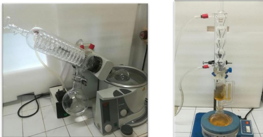
**Figure 9:** Montage d'extraction: Soxhlet et Rotavapeur.
