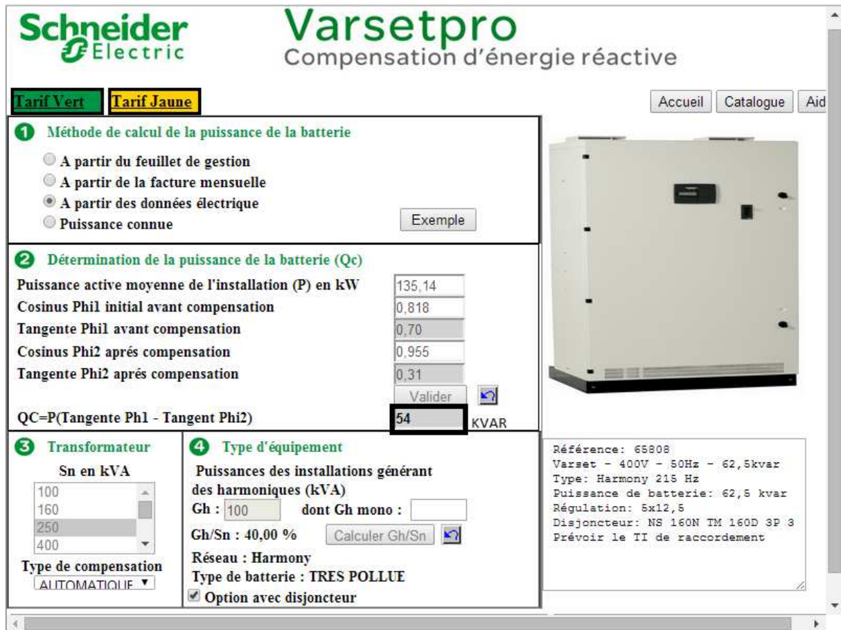
Figure 14 :: compensation en charge du TGBT usine par VarssetPro
