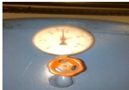
Figure 6.1 : mesure de la diminution de pression dans le système compresseur coupe en fonction du temps.
