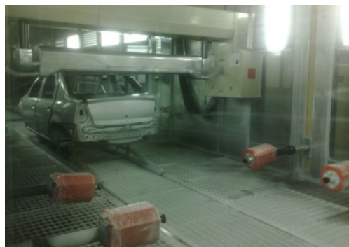
Figure 4.11: machine à bol de la ligne de la laque
