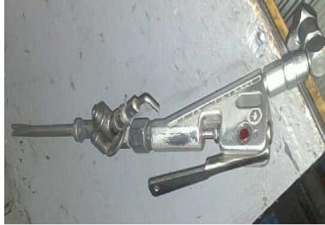
Figure 4.6 : pistolets de la ligne de Mastic
