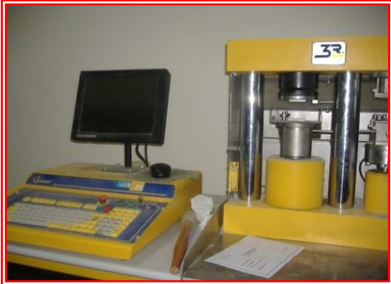
Figure 13: Appareil presse IBERTEST et le moule préparé
