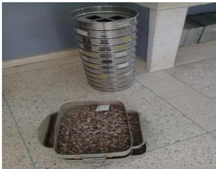
**Figure 2 :** les échantillons préparés pour l'essai d'analyse granulométrique
