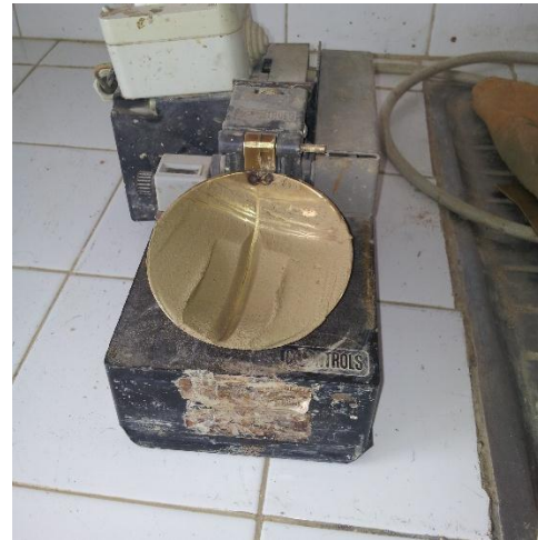
Figure 13: coupelle de Casagrande
