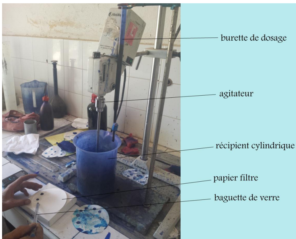
Figure 16: Essai de détermination de la valeur en bleu du sol
