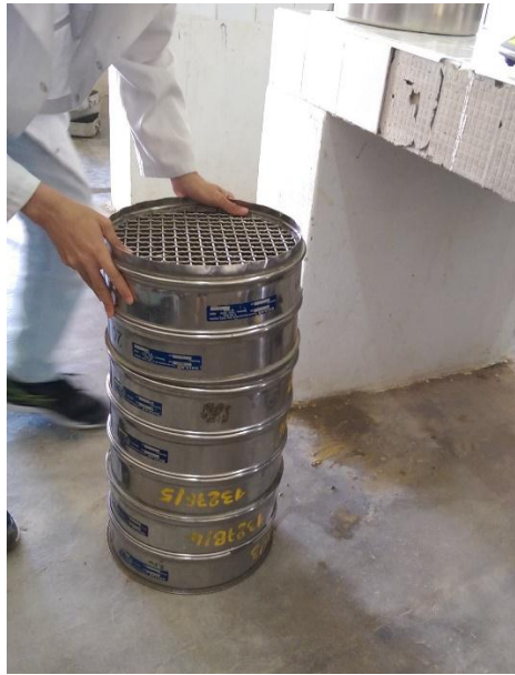
Figure 9: tamisage de l'échantillon
