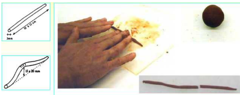
Figure 23 : Cylindre de 3mm de diamètre se brisant en tronçons de 10 à 20 mm
