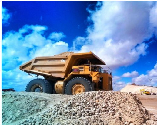
Photo 14 : transport du stérile par les camions de KOMATSU
