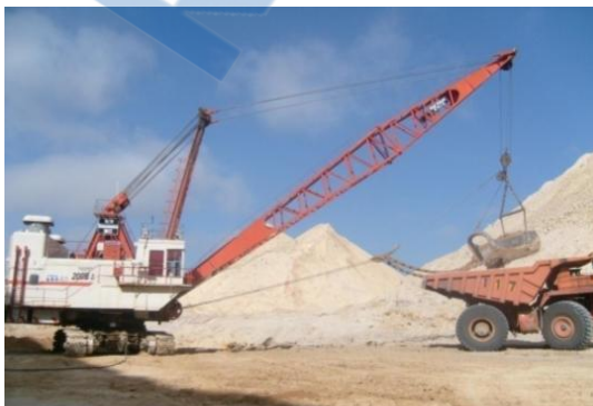
Photo 20 : Défruitage par dragline 200B
