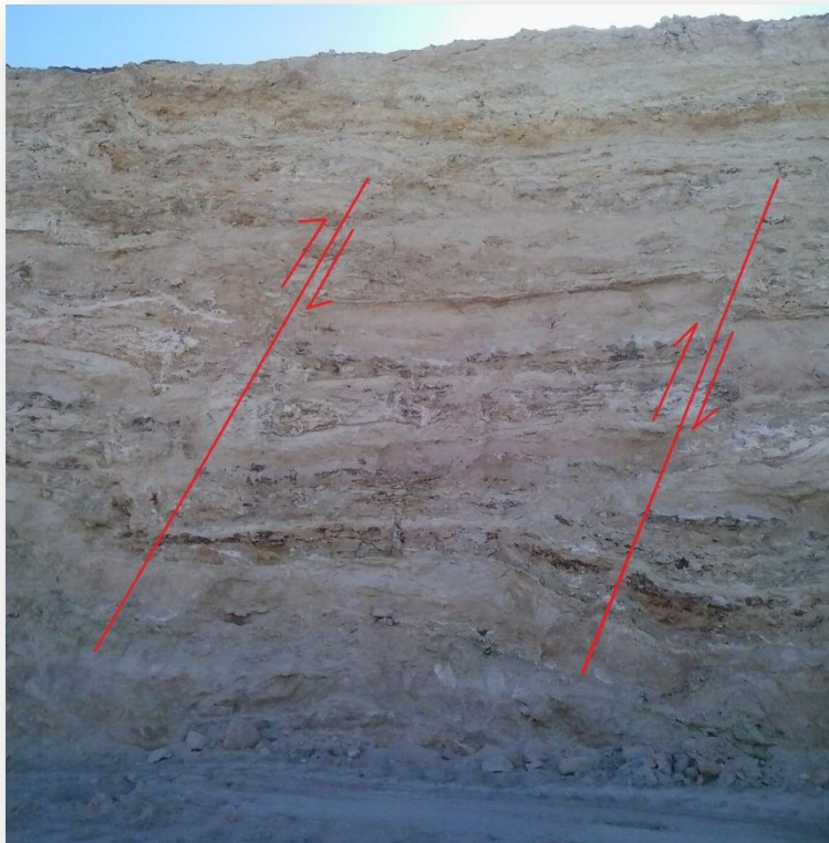
Figure 11 : Deux failles inverses qui affectent la série phosphatée
