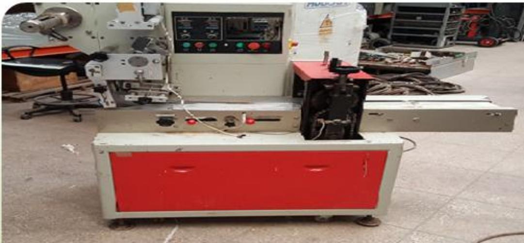
Figure 18 : machine d'emballage
