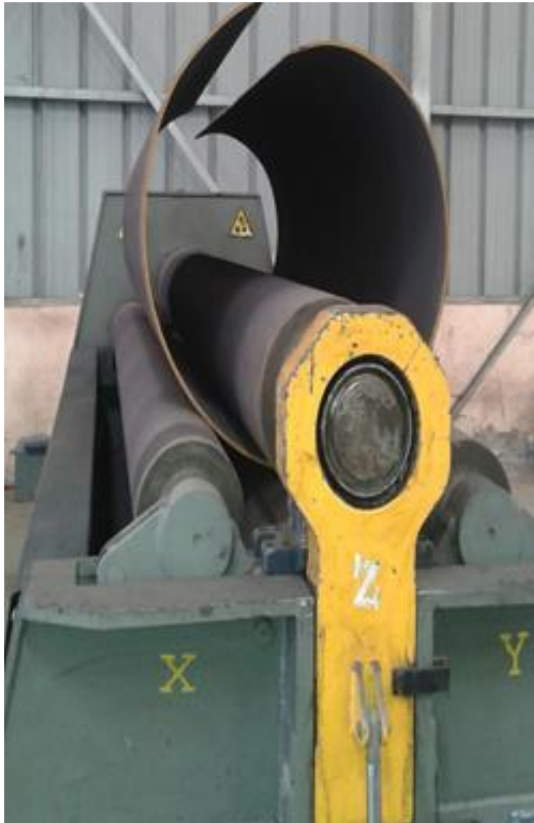
Figure 11: Cintrage d'un tôle
