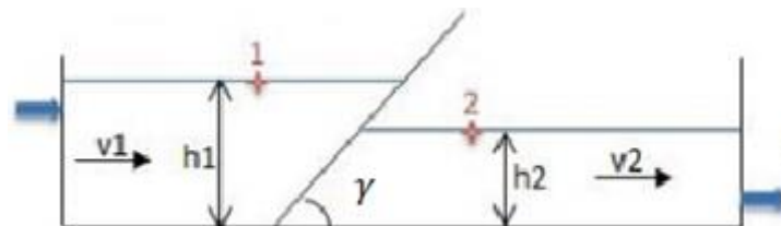
Figure III.2 : Caractéristiques en amont et en aval du dégrilleur
