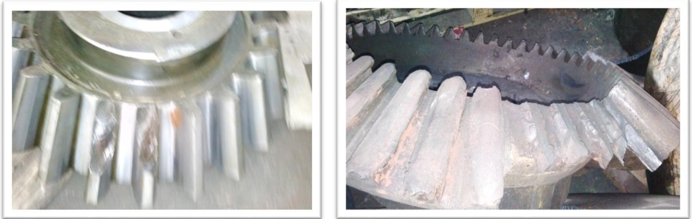
Figure 57: Rupture en cisaillement du pignon
