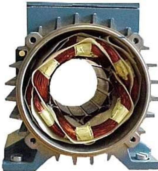
Figure 29:logement des bobines
