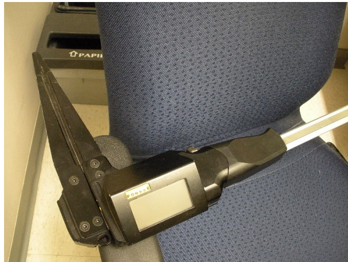
Figure 3.9 : Vernier électronique Ponsse Caliper+ (Photo : M. Bouchard)
