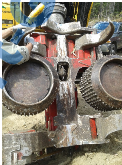
Figure 3.7 : Tête Log Max 7000 XT (Photo : M. Bouchard)
