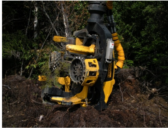
Figure 3.8 : Tête Ponsse H7 (Photo : M. Bouchard)
