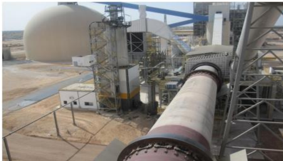
Figure 18: Four rotatif à 2 appuis (FLS Rotax-2), avec commande électrique.
