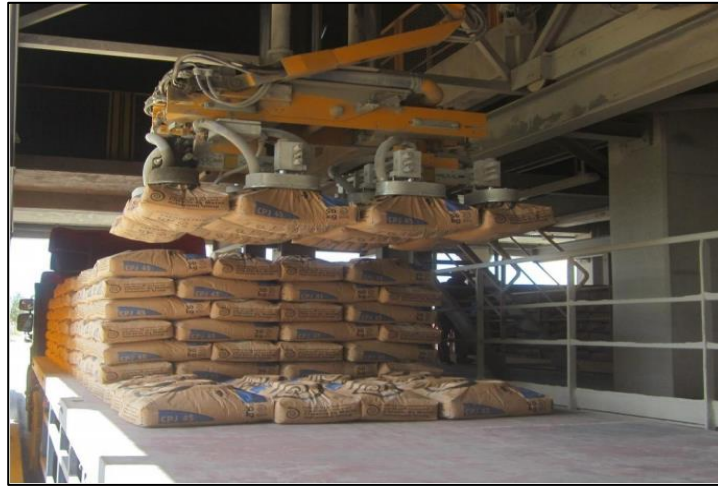
Figure 28: Machine CARICAMAT pour le chargement des camions.
