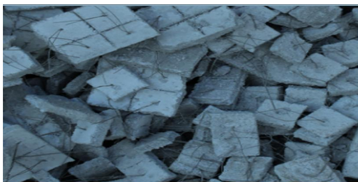
Figure 31 : Fabrication des cales bétons
