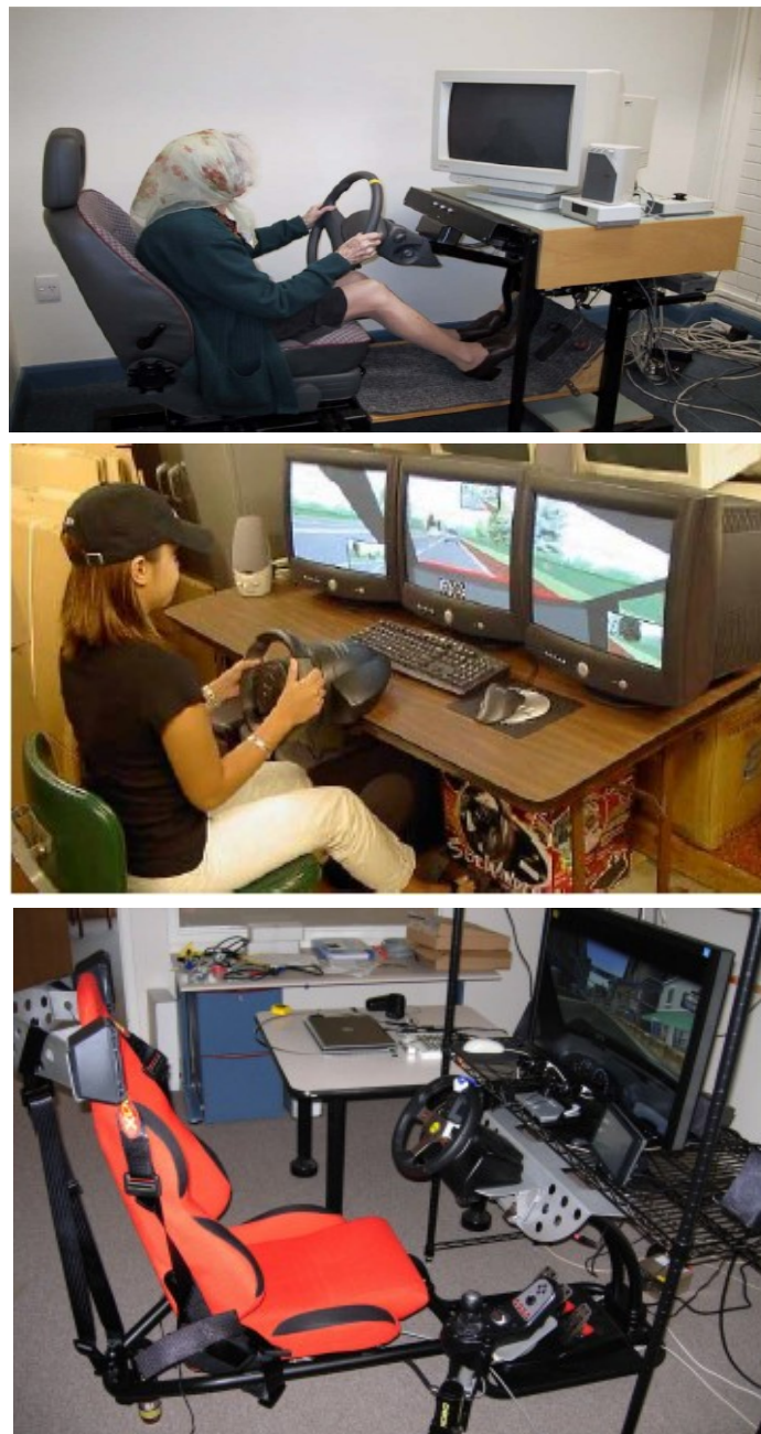
Figure 1 : Illustration de simulateurs de conduite « bas coût »
