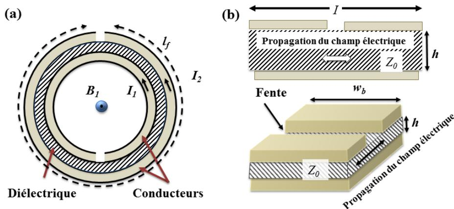
Figure II-5 : Principe du résonateur inductif rayonnant : a) ligne rétro-bouclée avec  $l_f$  (longueur moyenne de la ligne),  $I_1$ ,  $I_2$  (courants dans les 2 conducteurs),  $B_1$  (champ magnétique induit); b) ligne de transmission déroulée avec  $I$  (courant total),  $h$  (épaisseur du diélectrique),  $Z_0$  (impédance caractéristique),  $w_b$  (largeur du conducteur).
