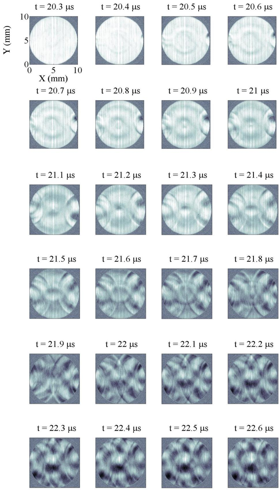
Figure III-7 : Images des signaux spatio-temporels  $S(x, y, t)$  de détection par l'excitation impulsionnelle (Impulsion générée à  $t=20\mu\text{s}$ ).
