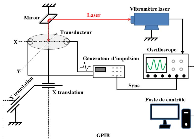
Figure III-1 : Banc expérimental.
