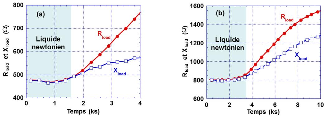
Figure I-8 : Variation typique de partie réelle  $R_{load}$  et de la partie imaginaire  $X_{load}$  à 6 MHz (a) par un gel de silice ( $[Si]_0 = 1,6 \text{ mol}\cdot\text{L}^{-1}$ ; Taux d'hydrolyse = 8; Température =  $25^\circ\text{C}$ ); (b) par un lait ( $[GDL] = 26 \text{ g}\cdot\text{L}^{-1}$ ; Température =  $37,5^\circ\text{C}$ ).  $[Si]_0$  est la concentration molaire de Silice,  $[GDL]$  est la concentration molaire de GDL (glucono- $\delta$ -lactone)
