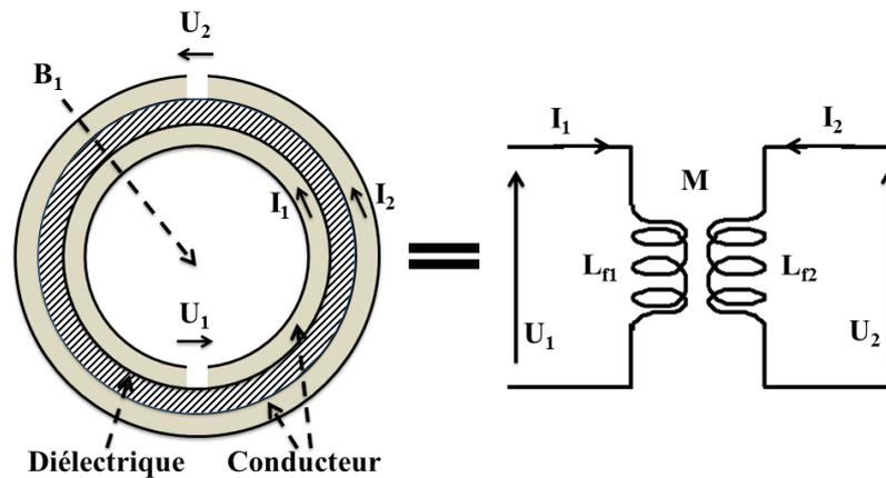
Figure II-6 : Schéma électrique équivalent du circuit double bande avec une fente.  $M$  est la mutuelle entre les deux circuits.  $L_{f1}$  et  $L_{f2}$  sont les inductances de chaque bande conductrice.
