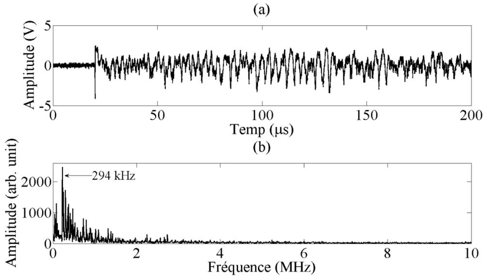
Figure III-6 : (a) Le signal  $S(x_0, y_0, t)$  avec  $x_0 = 3,5\text{mm}$  et  $y_0 = 3,5\text{mm}$  ; (b) le spectre du signal  $S(x_0, y_0, t)$ .
