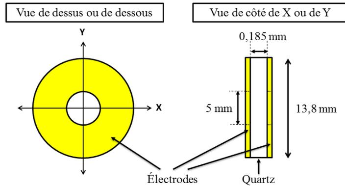
Figure II-17 : Schéma du quartz résonant à 9 MHz.
