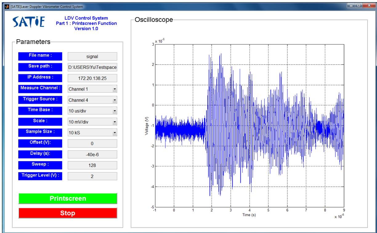
Figure III-2 : Interface graphique de la manipulation du banc de mesure sans translation.
