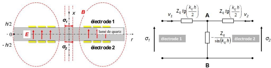
Figure IV-4 : Schéma équivalent du transducteur à quartz de coupe AT d'un point de vue mécanique.
