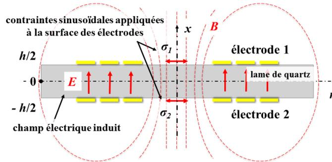
Figure IV-3 : Le TSMMA utilisé en tant que capteur
