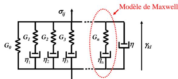
Figure I-2 : Exemple de modèle mécanique représentatif des matériaux viscoélastiques isotropes : modèle généralisé de Maxwell. Ce modèle est constitué de  $n$  branches de Maxwell en parallèle ayant chacune un module de rigidité  $G_i$  et une viscosité  $\eta_i$  propre.
