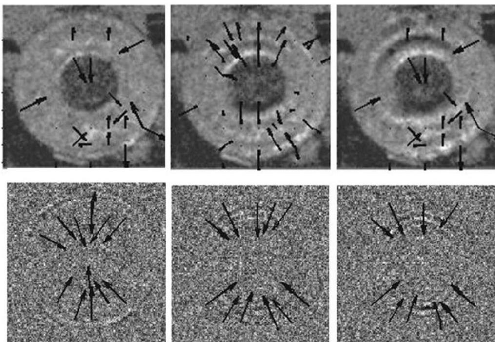
Figure III-26 : L'analyse de Gabor de la configuration des électrodes annulaires. En haut,  $f = 0,8$  MHz et de gauche à droite pour le temps de  $0 \mu s$ ,  $1 \mu s$  et  $2 \mu s$ . En bas,  $f = 2,1$  MHz et de gauche à droite pour le temps de  $0 \mu s$ ,  $1 \mu s$  et  $2 \mu s$ .
