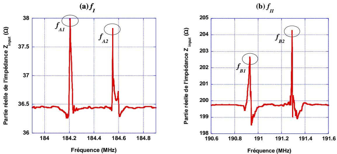
Figure IV-12 : Extraction de la variation mécanique (hors influence de la résonance électromagnétique) a) à l'harmonique 51, b) à l'harmonique 53.
