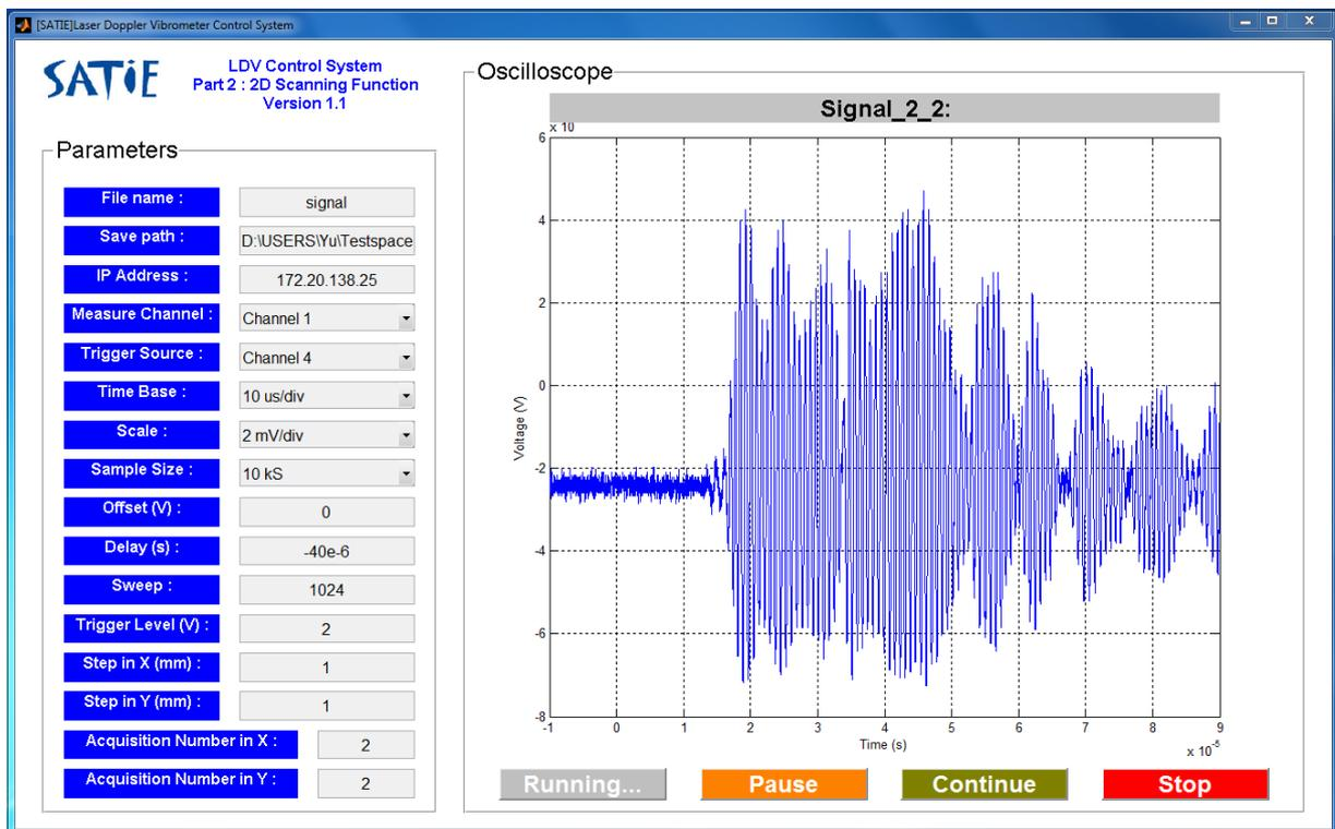
Figure III-3 : Interface graphique de la manipulation du banc de mesure suivant les axes X et Y.
