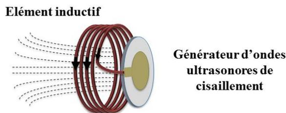
Figure II-1 : Concept du capteur TSMMA : schéma éclaté des éléments principaux.
