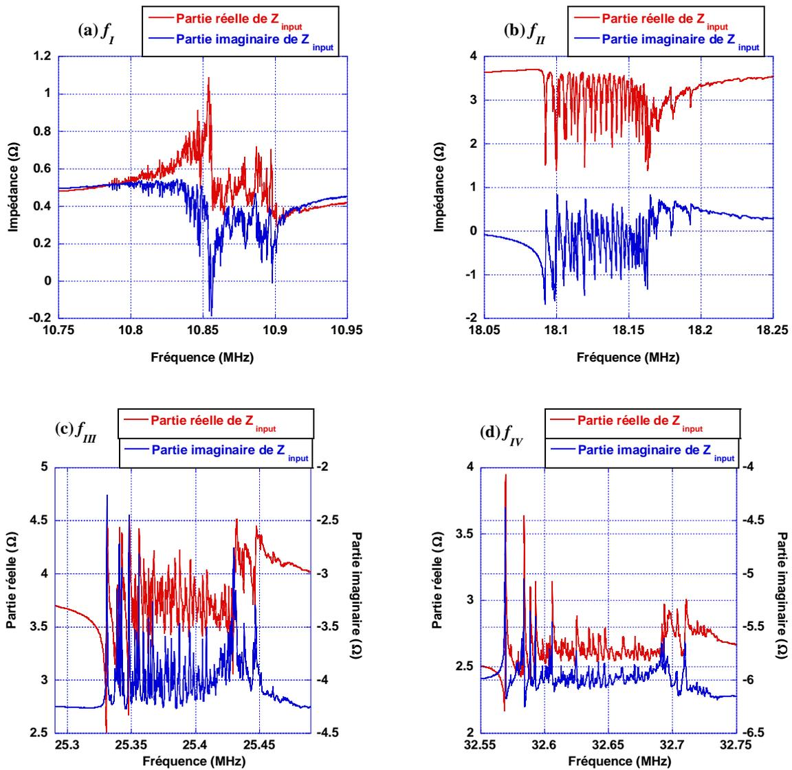
Figure IV-16 : Zoom sur les résonances intéressantes dans la mesure d'impédance du transducteur TSMMA multi-tour.
