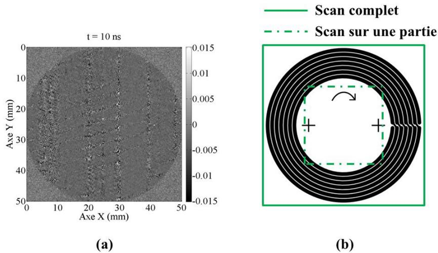
Figure IV-20 : (a) Résultat du scan complet sur toute la surface du transducteur TSMMA ( $50 \text{ mm} \times 50 \text{ mm}$ ) avec un pas spatial de  $0,25 \text{ mm}$  à l'instant  $t=10 \text{ ns}$  ; (b) repérage de la zone du scan complet (en ligne verte) et du scan sur une partie (en tiret-point vert).
