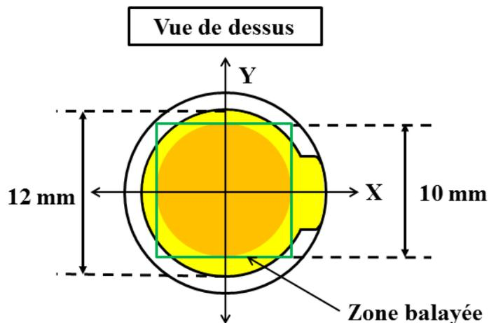
Figure III-4 : La zone balayée pour le vibromètre laser.
