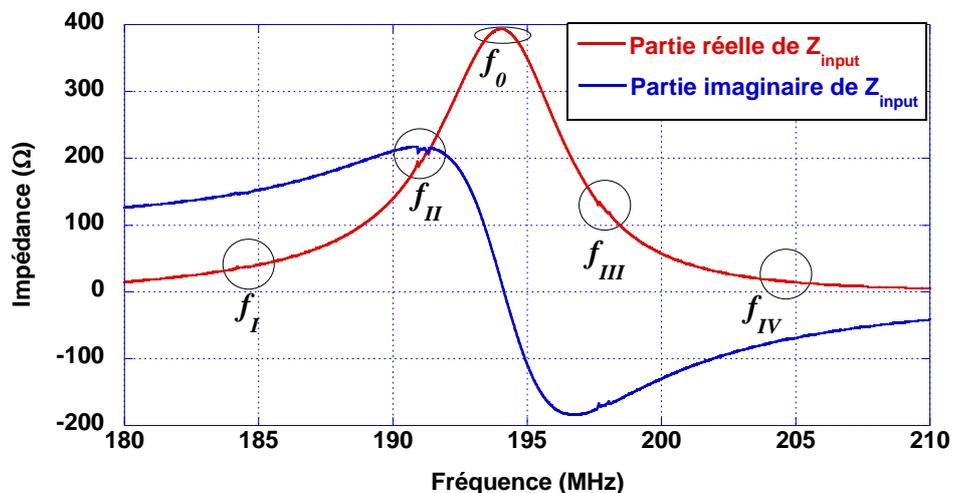
Figure IV-10 : Mesure de l'impédance d'entrée de la sonde couplée au TSMMA uni-tour ( $f_0 = 194\text{MHz}$  et  $Q_0 = 53$ ).
