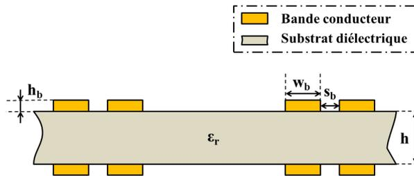
Figure II-10 : Résonateur RF multi-tour (vue en coupe transversale).
