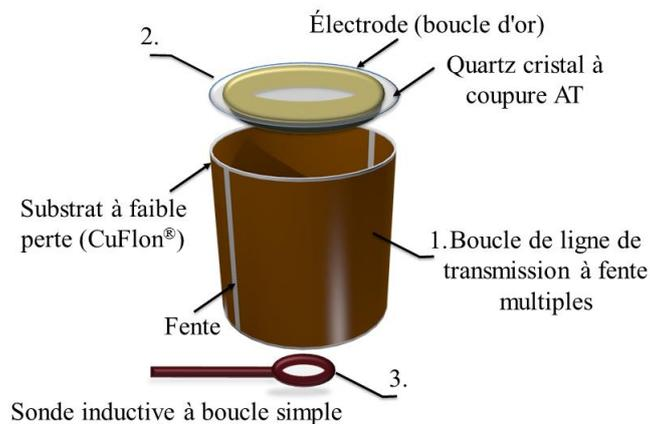
Figure II-18 : Le capteur totalement inductif composé de deux résonateurs distincts - 1. L'élément sensible au champ magnétique RF; 2. Le disque de quartz de coupe AT excité par électrodes en forme de boucle (le résonateur TSM); 3. La sonde permettant une mesure par réflectométrie
