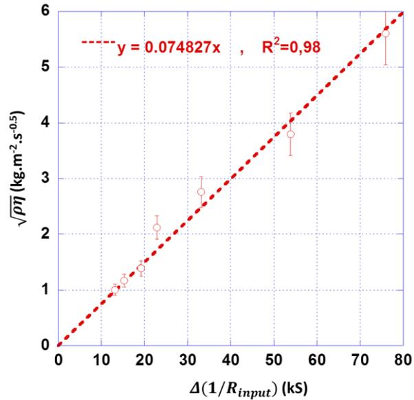
Figure II-22 : La racine carrée de produit de masse volumique-viscosité en fonction de la partie réelle de l'admittance d'entrée de la sonde pour des mélanges eau-glycérol entre 0% et 70%.
