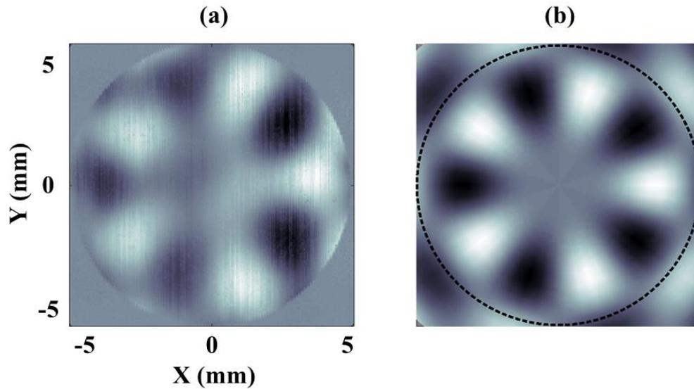
Figure III-10 : (a) Résultat expérimental : le signal spatio-fréquentiel  $W(x, y, \omega)$  en  $f = 300$  kHz ; (b) résultat théorique : la mode propre de flexion d'un disque en  $f = 300$  kHz.
