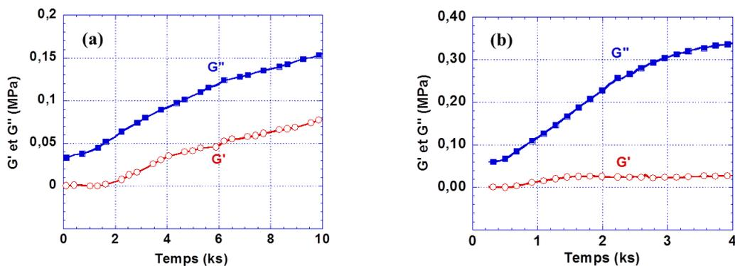
Figure I-9 : Variation typique du module élastique  $G'$  et du module visqueux  $G''$  à 6 MHz pour (a) par le gel de silice ( $[Si]_0 = 1,6 \text{ mol}\cdot\text{L}^{-1}$ ; Taux d'hydrolyse = 8; Température =  $25^\circ\text{C}$ ); (b) par le yaourt ( $[GDL] = 26 \text{ g}\cdot\text{L}^{-1}$ ; Température =  $37,5^\circ\text{C}$ ).
