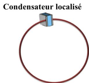
*Figure II-2 : Résonateur à capacité d'accord localisée.*
