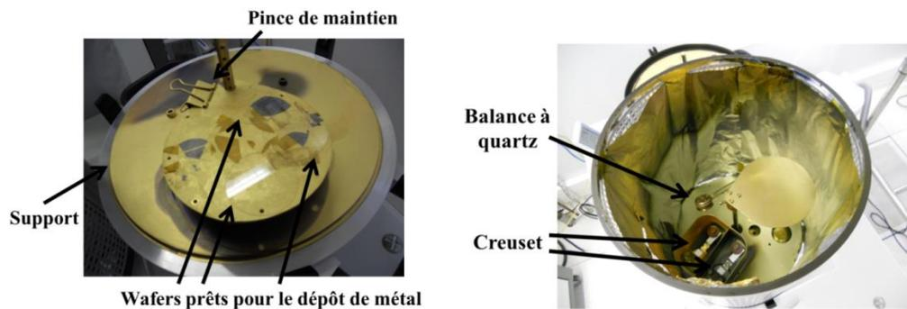
Figure IV-7 : Installation de wafer sur le couvercle et Vue intérieure de l'évaporateur.
