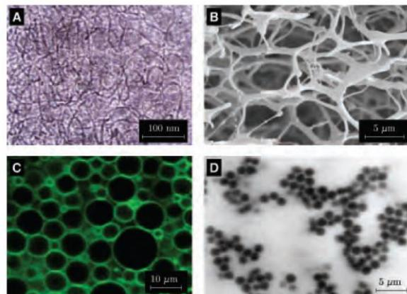
Figure I-1 : Microstructures de matériaux de la famille des "matières molles" : A- Micelles géantes vues au microscope électronique [12]; B- Structure d'un gel de carbopol [13]; C- Emulsion concentrée vue au microscope confocal; D- Gel colloïdal vu au microscope confocal.
