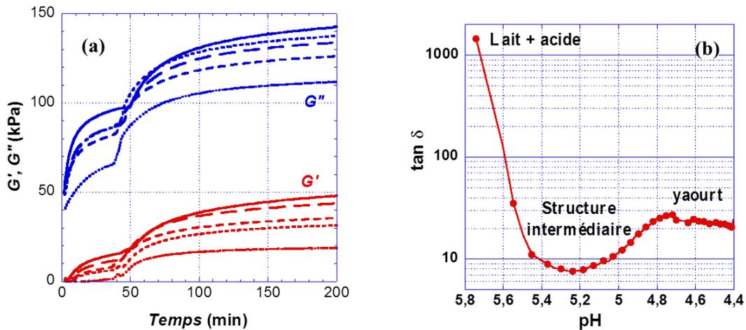
Figure I-10 : (a) Evolution d'un gel hybride de PHEA/SiO<sub>2</sub> à différents du taux de silice [57] ; (b) comportement viscoélastique typique d'une restructuration lors de la formation de yaourt [46].
