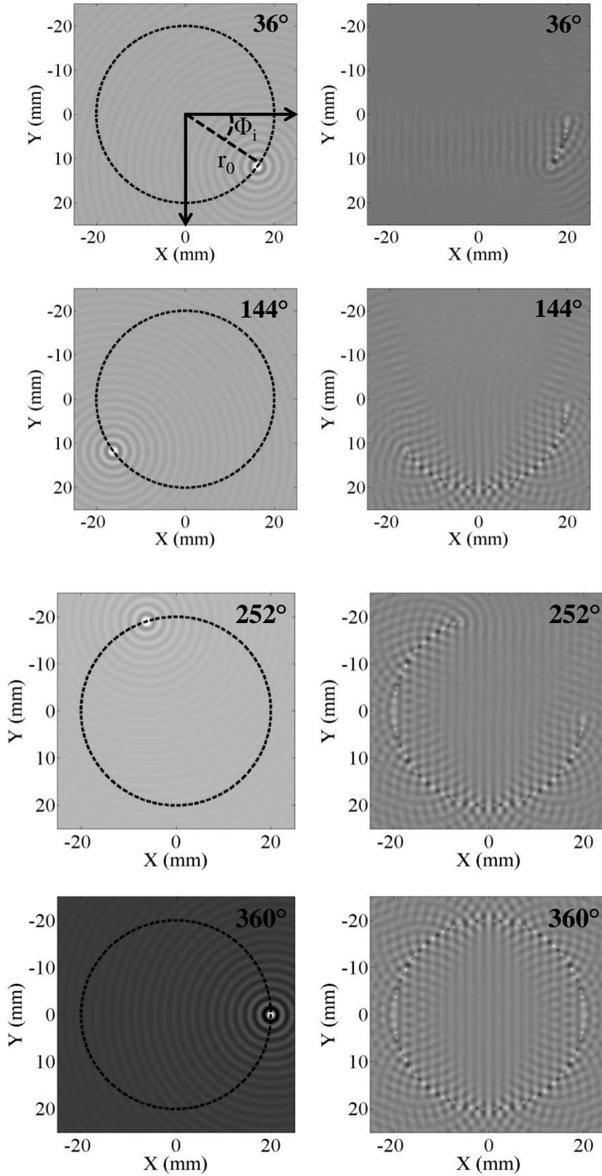
Figure B-15 : (a) Toutes les images à gauche sont les simulations des ondes acoustiques circulaires sur un anneau avec les sources ponctuelles ( $S_i$ ) réparties à certain angle ( $\Phi = 36^\circ$ ,  $144^\circ$ ,  $252^\circ$ , et  $360^\circ$ ). (b) Toutes les images à droite sont la somme de sources ponctuelles ( $S_i$ ) précédentes.
