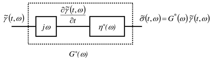
Figure I-4 : Module complexe de cisaillement : fonction de transfert équivalente. Notons que par identification avec la loi de Newton, on peut définir une viscosité complexe  $\eta^*$  également caractéristique des matériaux viscoélastiques.
