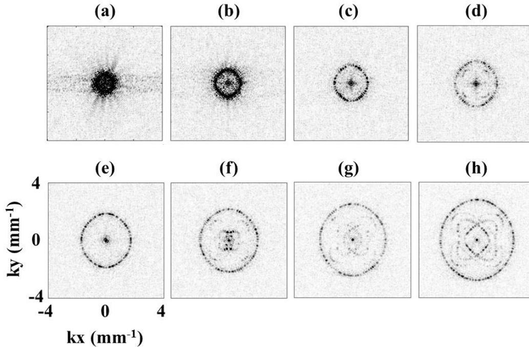
Figure III-14 : Images des signaux nombre de l'onde-fréquentiels  $K(k_x, k_y, \omega)$  dans une gamme de fréquences comprise entre 1 MHz et 8 MHz. (a)  $f = 1$  MHz ; (b)  $f = 2$  MHz ; (c)  $f = 3$  MHz ; (d)  $f = 4$  MHz ; (e)  $f = 5$  MHz ; (f)  $f = 6$  MHz ; (g)  $f = 7$  MHz ; (h)  $f = 8$  MHz .
