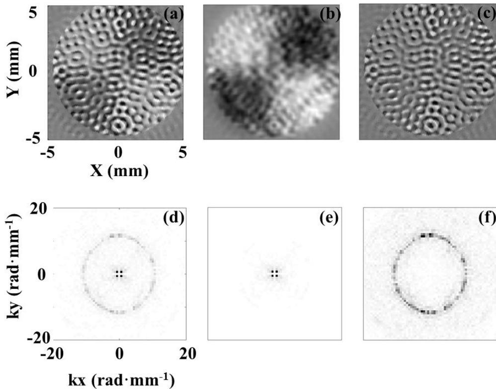
Figure III-18 : (a) Le signal spatio-fréquentiel  $W(x, y, \omega)$  en fréquence de 5 MHz ; (b) le signal filtré de (a) par un filtre passe-bas 2D à réponse impulsionnelle finie ; (c) la soustraction de (a) à (b) ; (d) Le signal nombre de l'onde-fréquentiel  $K(kx, ky, \omega)$  de (a) ; (e) le  $K(kx, ky, \omega)$  de (b) ; (f) le  $K(kx, ky, \omega)$  de (c).
