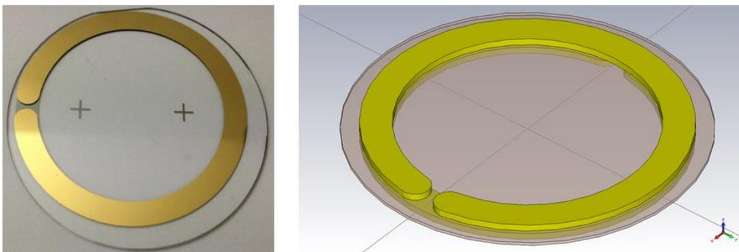
Figure IV-9 : Photo et image 3D du premier prototype TSMMA à un tour.
