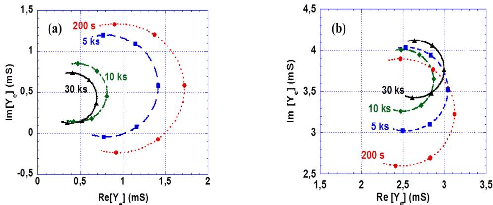
Figure I-6 : Admittance  $Y_e$  dans le plan complexe du quartz chargé (a) par un gel de silice ( $[Si]_0 = 1,6 \text{ mol}\cdot\text{L}^{-1}$  ; taux d'hydrolyse = 8 ; Température =  $25^\circ\text{C}$ ) ; (b) par un yaourt élaboré à partir d'un lait acidifié ( $[GDL] = 26 \text{ g}\cdot\text{L}^{-1}$  ; Température =  $37,5^\circ\text{C}$ ).  $[Si]_0$  est la concentration molaire de Silice,  $[GDL]$  est la concentration molaire de GDL (glucono- $\delta$ -lactone).
