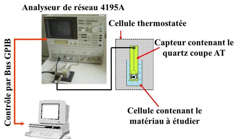
Figure I-5 : Banc de mesure rhéologique haute fréquence.
