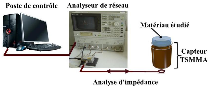
Figure II-19 : Technique de mesure magnéto acoustique inductif.
