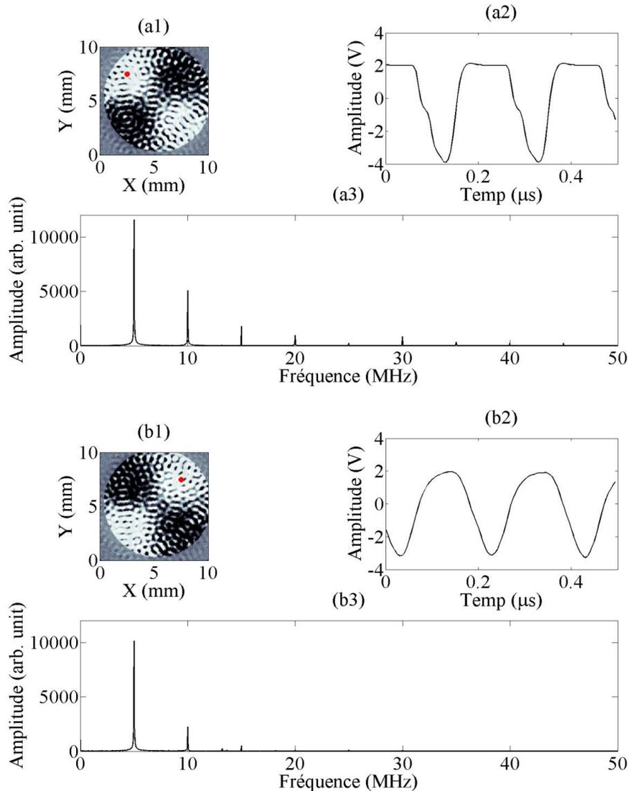
Figure III-17 : (a1) Le signal spatio-temporel  $S(x, y, t)$  à l'instant  $t = 0,04 \mu\text{s}$  ; (a2) le signal  $a(t)$  pour le point en rouge de  $X = 2,5 \text{ mm}$  et  $Y = 7,5 \text{ mm}$  ; (a3) le spectre du signal  $a(t)$  ; (b1) le signal spatio-temporel  $S(x, y, t)$  à l'instant  $t = 0,14 \mu\text{s}$  ; (b2) le signal  $b(t)$  pour le point en rouge de  $X = 7,5 \text{ mm}$  et  $Y = 7,5 \text{ mm}$  ; (b3) le spectre du signal  $b(t)$ .
