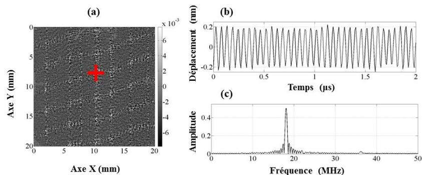
Figure IV-21 : (a) Résultats de signal  $S(x, y, t_0)$  détecté par un scan complet de laser ; (b) Signal temporel et (c) son spectre d'un point marqué en croix rouge sur (a).
