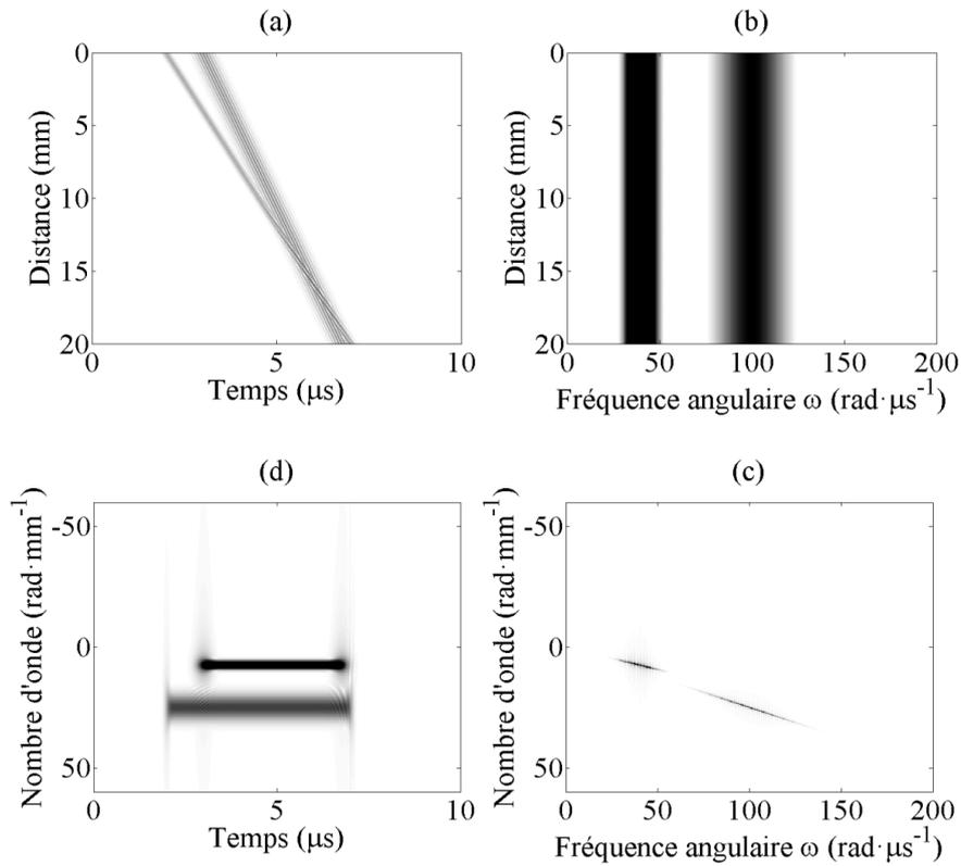
Figure B-4 : (a) Le signal 2D de  $S(t, x)$  avec deux impulsions de  $40 \text{ rad}\cdot\mu\text{s}^{-1}$  et  $100 \text{ rad}\cdot\mu\text{s}^{-1}$  ; (b) le signal de  $S(\omega, x)$  ; (c) le signal de  $S(\omega, k)$  ; (d) le signal de  $S(t, k)$ .
