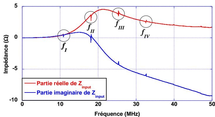
Figure IV-15 : Mesure d'impédance du transducteur TSMMA multi-tour.
