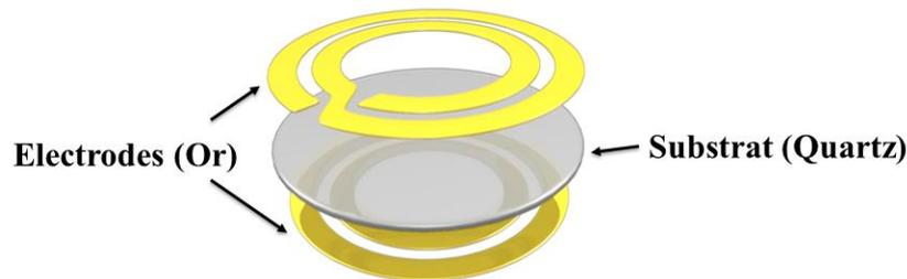
Figure IV-1 : Concept du TSMMA "on-chip" : architecture éclatée.
