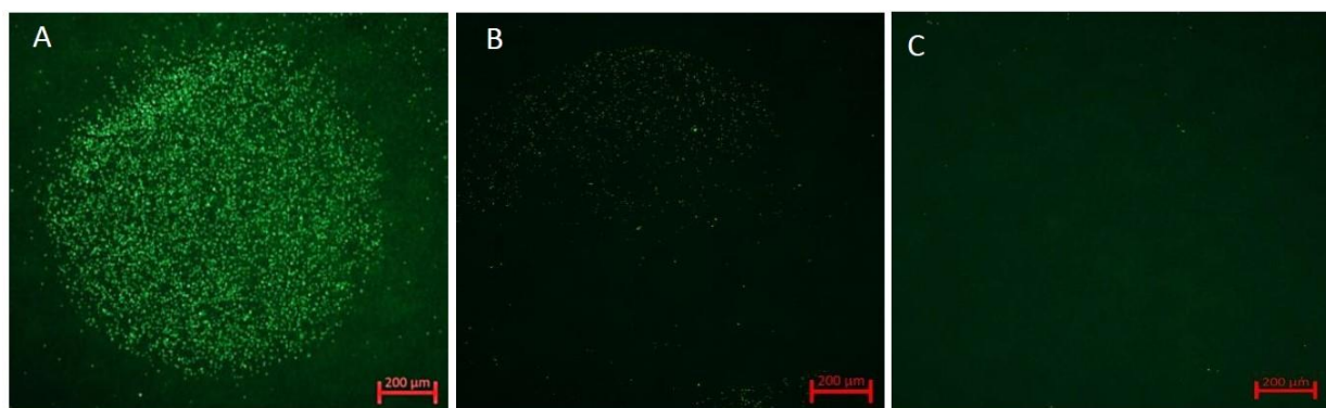
Figure IV.12 - Image en microscopie à fluorescence, (en grossissement x5), des spots de capture, d'un échantillon de NPs en PPL. A) Spot anti-OVA. B) Spot anti-CAS. C) Spot anti-CD41. (Longueur d'onde 506 / 536 nm, temps d'exposition de quelques millisecondes.)
