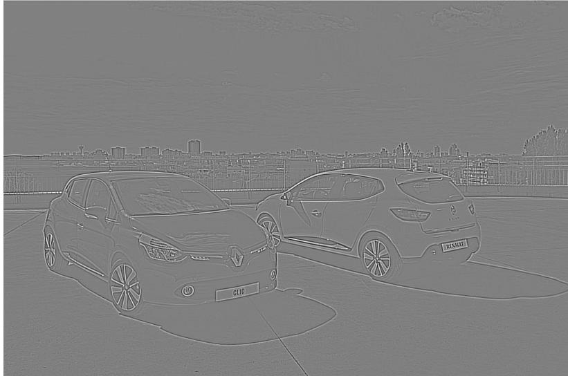
FIGURE 2.7 – Résultat d'un filtre DoG  $\sigma_1 = 1$  et  $\sigma_2 = 3$ .
