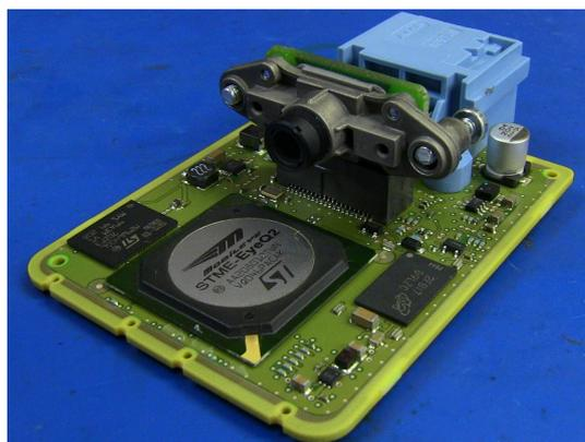
FIGURE 1.2 – Capteur EyeQ2 de Mobileye
