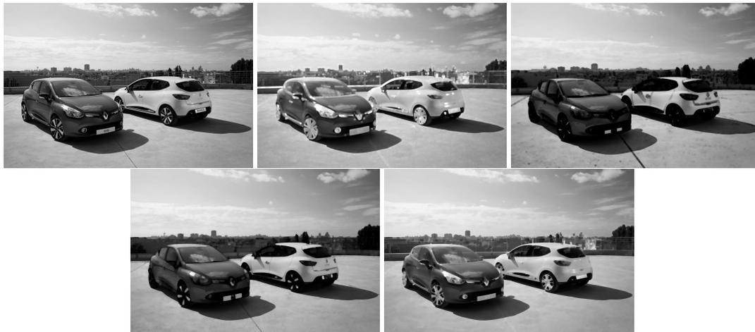
FIGURE 2.9 – Opérations morphologiques de base pour des images en niveaux de gris. De gauche à droite puis de haut en bas : image original, dilatation, érosion, ouverture, fermeture. Les opérations ont été faites avec un élément structurant de forme disque de rayon 3.5 pixels.
