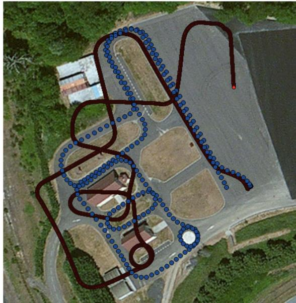
FIGURE A.5 – Vue satellite représentant la trajectoire obtenue par l'algorithme (en noir) et la trajectoire obtenue par le GPS RTK (en bleu). La vue satellite est extraite de Bing Maps.
