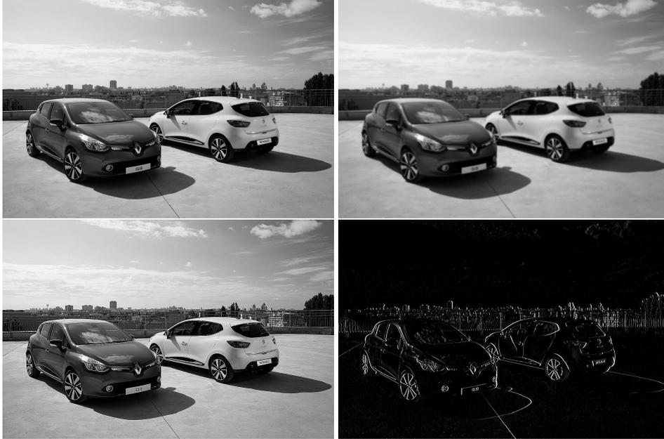
FIGURE 2.6 – Différents filtres de convolution. De gauche à droite puis de haut en bas : l'image original, filtre Gaussien, rehaussement de contour, filtre de Sobel en  $x$ .
