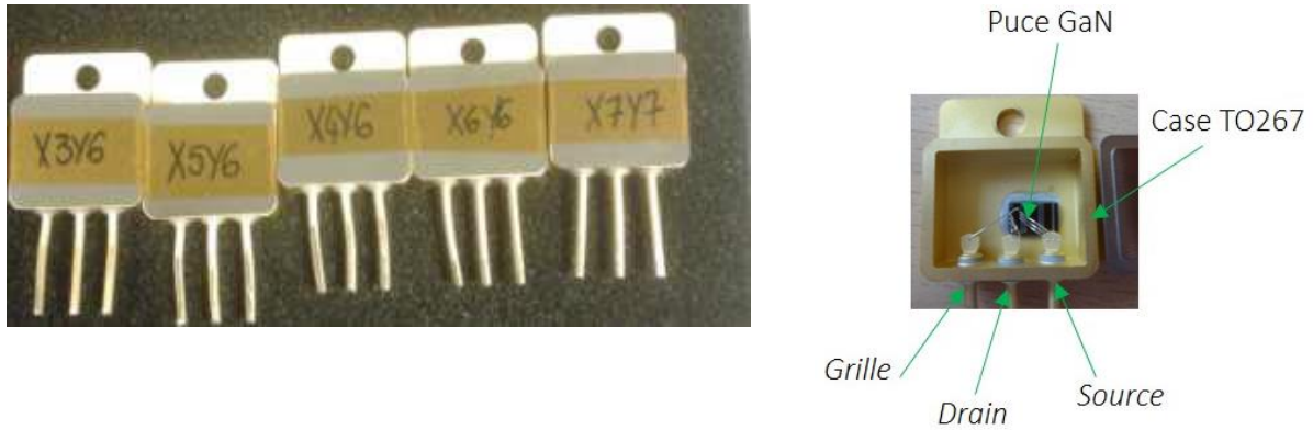
Figure II. 24: Gauche : Boîtier en métal (TO267), Droite : Composant Normally-Off
