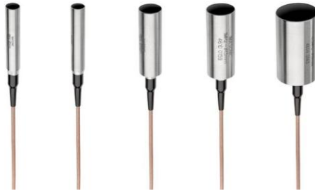
Figure 1-54 Différents capteurs de différentes fréquences d'émission: 0,5 ;1 ;2 ;4 ;8 Mhz
