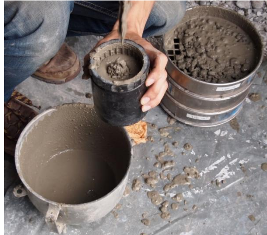
Figure 3-10 Prélèvement du mortier par tamisage
