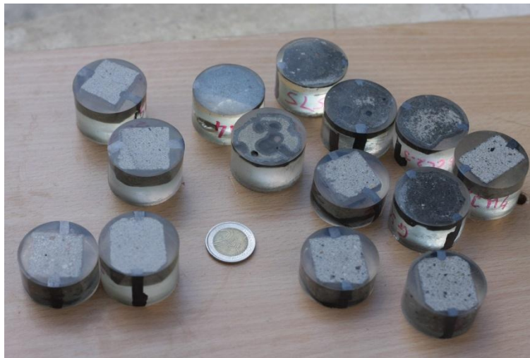
Figure 4-11 Echantillons de couche limite et de mortier à observer au MEB
