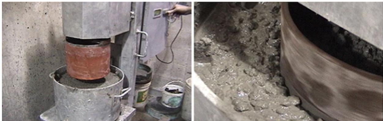
Figure 1-42 Tribomètre développé par Chapdelaine (Chapdelaine 2007)
