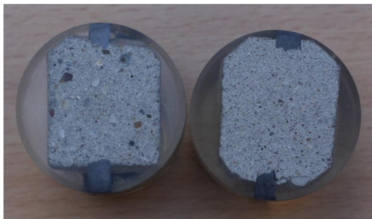
Figure 4-12 Comparaison visuelle entre une échantillon de mortier (à gauche) et une échantillon de couche limite (à droite)
