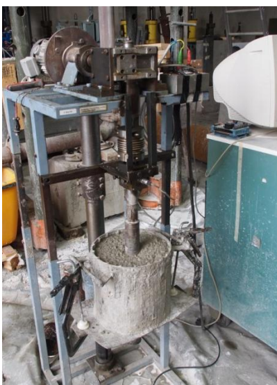
Figure 3-9 Essai rhéologique avec le rhéomètre à béton Tattersall MK-II
