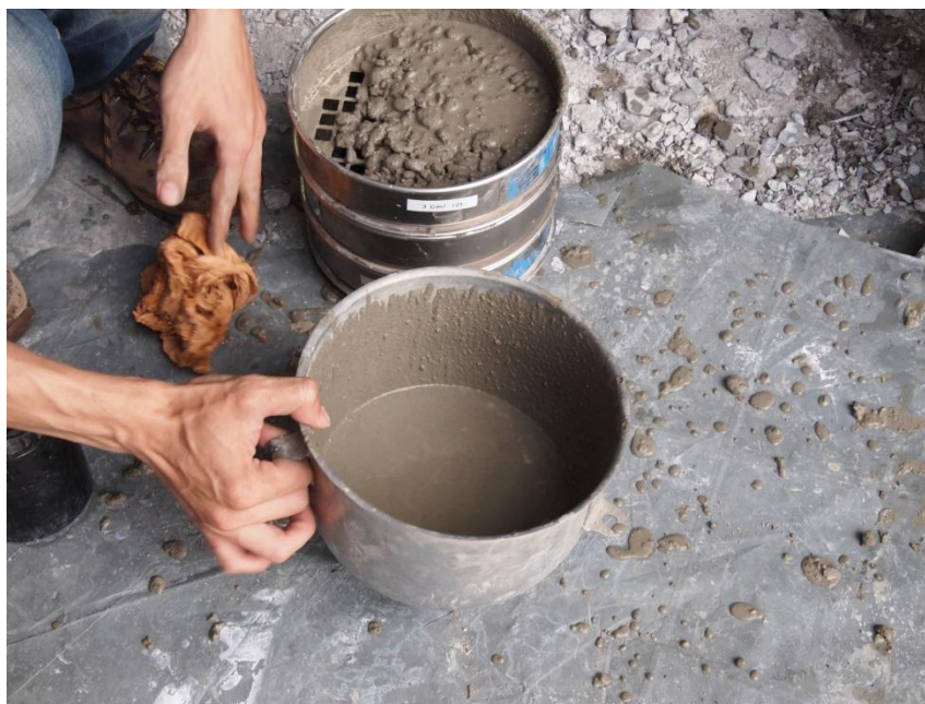
Figure 4-3 Tamiser un des cinq bétons avec le système composé de trois tamis d'ouvertures 10 mm, 8 mm et 4 mm
