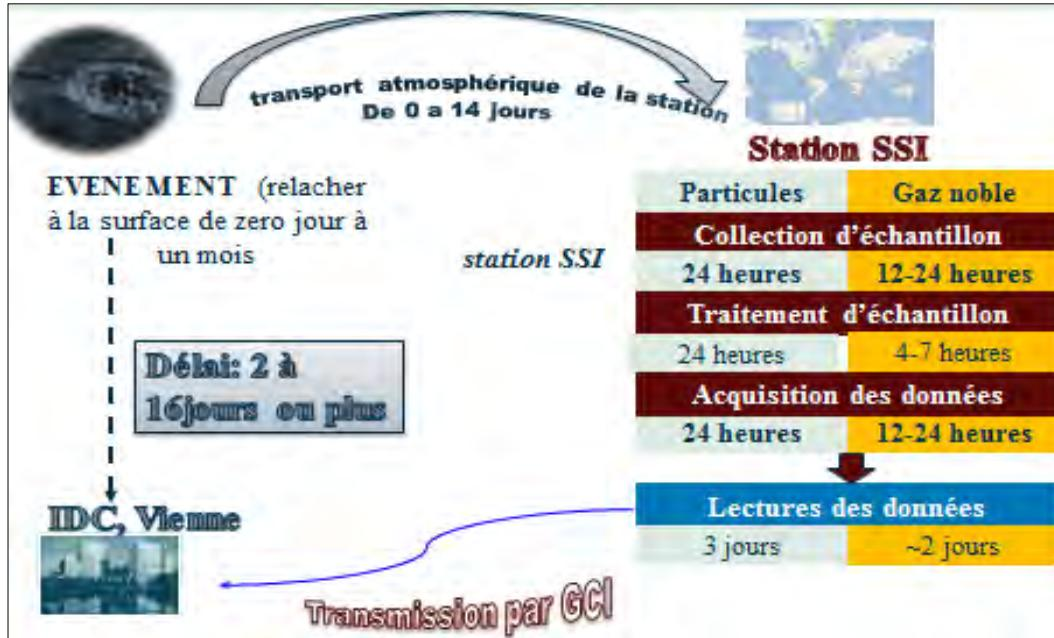
Figure 20: Chronologie de libération à la détection des radionucléides [11].
