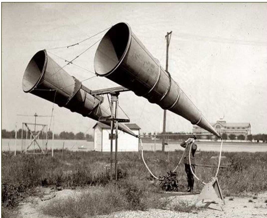
Télésimètre à l'essai (USA, années 1920) 5
