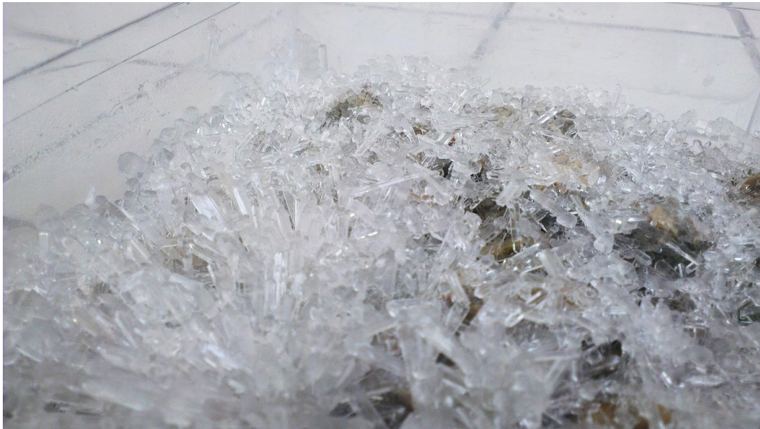
Figure 2-19. Résultat de la cristallisation du sulfate de sodium au contact des granulats de laboratoire
