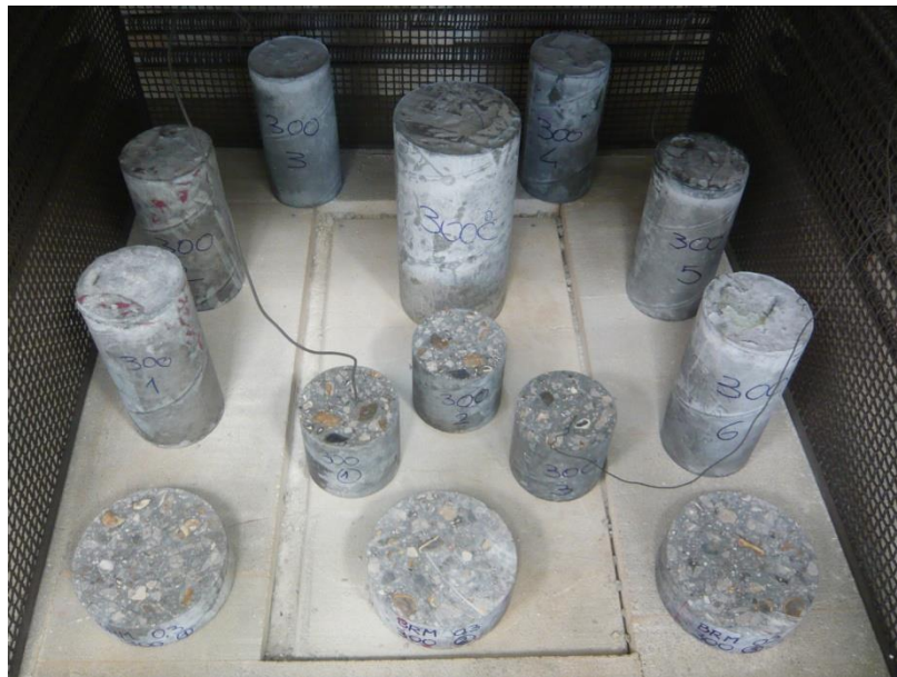
Figure 4-3. Disposition des éprouvettes dans le four
