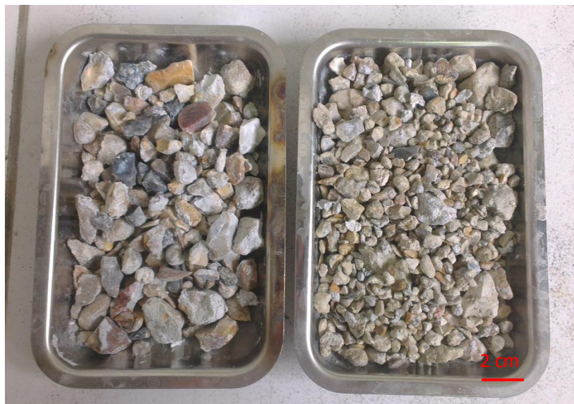
Figure 2-20. Aspect des granulats après retrait de la gangue de mortier, à gauche : GRL, à droite : GRI
