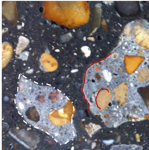
Figure 3-8. Différentes interfaces dans les bétons de granulats recyclés
