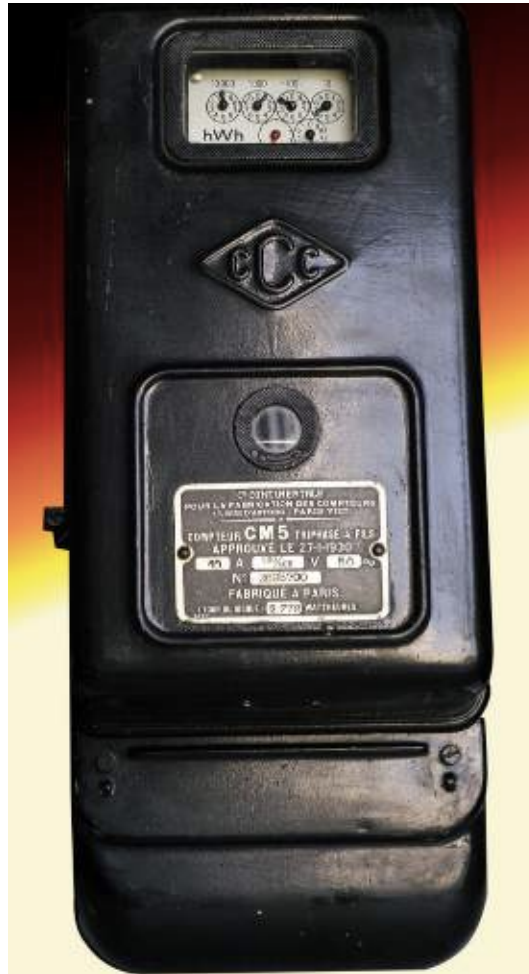
Fig. 5 — Compteur à induction, puissance estimée à 6,92 kW, 1930 (Source : Ph. Maillet, 2016) 1
