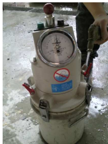
Figure II-11 : a) Contrôle de l'affaissement du béton frais. b) Mesure de la teneur en air du béton frais
