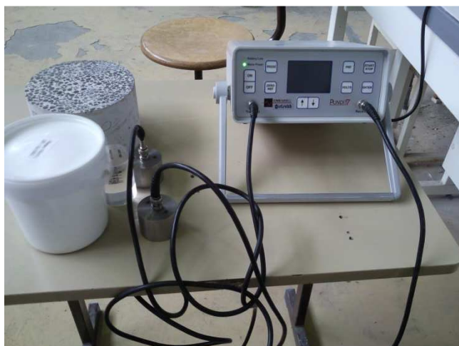
Figure II-14 : Dispositif de mesure du module d'élasticité dynamique
