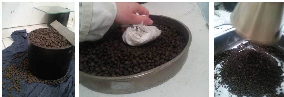
Figure II-6 : a) Mesure de la masse volumique en vrac. b) Etat saturé surface sèche du gravillon 700A c) Etat saturé surface sèche du sable léger 650A
