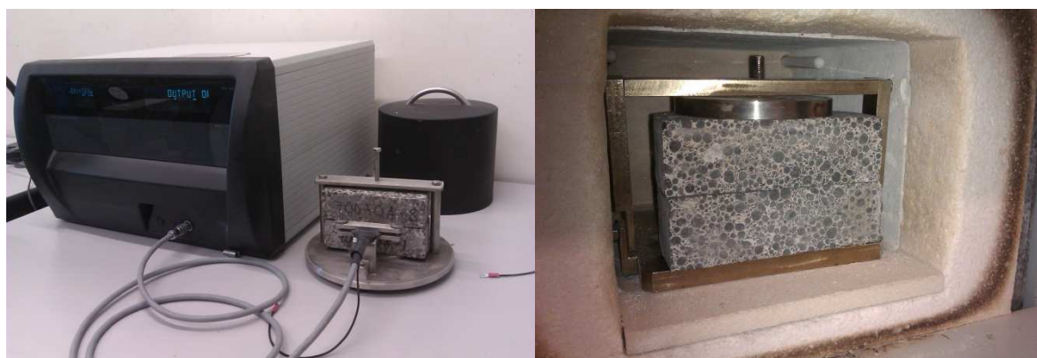
Figure II-18 : a) Centre d'acquisition de Hot Disk. b) Mesure à température 35°C et 50°C
